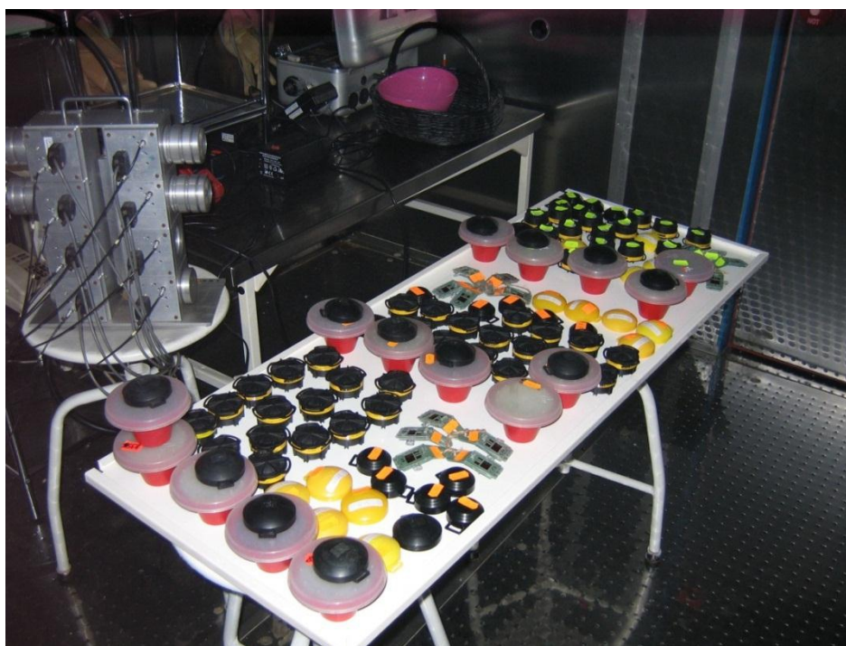
Rys. 5. Komory dyfuzyjne z detektorami CR-39 podczas eksperymentu porównawczego w komorze radonowej CLOR.
