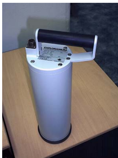
Fig. 4. GPX-21A – portable NaI(Tl) detector
