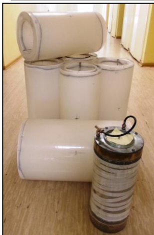
Wysoko-ciśnieniowa komora jonizacyjna ^{10}\text{B} z moderatorem polietylenowym
